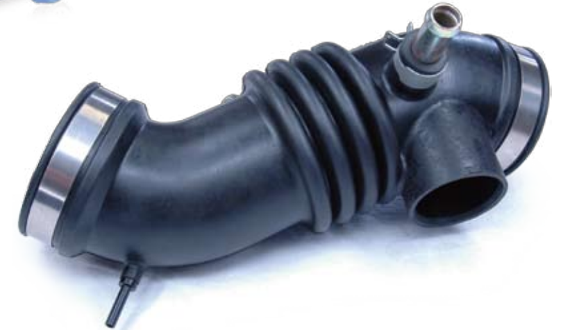
エアダクト エンジンへクリーンエアを 誘導させるためのホース
